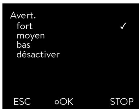
Fig. 35: Régler l'intensité sonore
